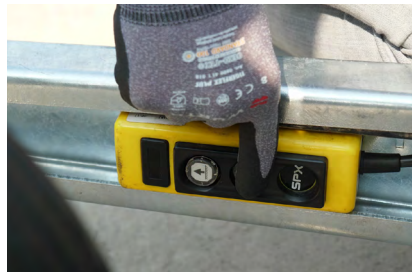
Figur 2: bruk av elektrisk pumpe
